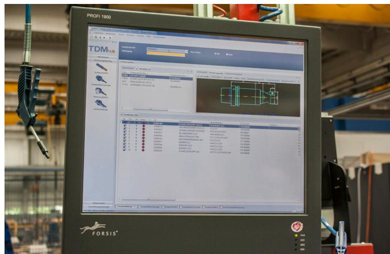
Der TDM-Auftrag zeigt die Liste der Einzelkomponenten und eine Zeichnung des zu montierenden Komplettwerkzeugs.
