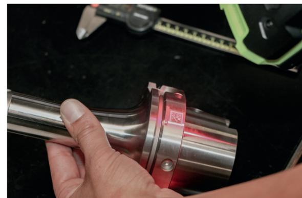
Le scan du code Datamatrix déclenche le transfert automatique des données dans la commande de la machine.
